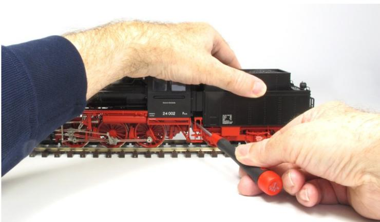
Während Sie den Tender zur Lok drücken, heben Sie mit einem feinen Schraubendreher den Fallhebel über die Nocke an.
