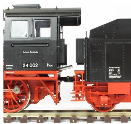
...und bewegen Sie ggf. den Tender leicht in Querrichtung zum Gleis, damit der Führungsdorn in die Aufnahme am Tender gleitet.
